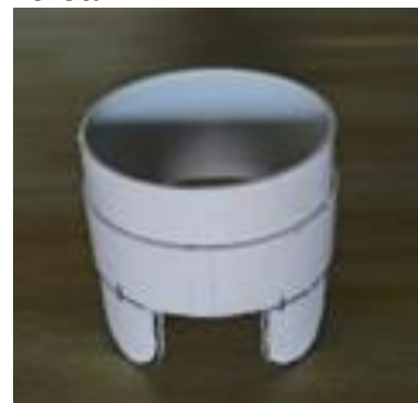
Gambar 14. Gabungan Pipa yang Telah di Potong dengan Dudukan Lampu
